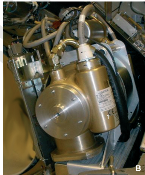
Figure 26. Tube scanographique (A, B). Refroidissement par rayonnement. La chaleur rayonnée par l'anode est transmise à travers les parois du tube au bain d'huile qui l'entoure. Le circuit d'huile comporte un réservoir (2) et une pompe qui mobilise l'huile chauffée et l'amène sous le flux gazeux à haut débit produit par les ventilateurs (1) réalisant le refroidissement par convection.
