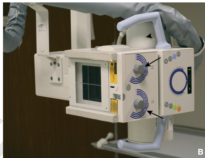
Figure 23. La mobilisation manuelle des diaphragmes s'effectue par rotation des boutons de commande (flèches). L'ensemble diaphragmes localisateurs et centreur lumineux est ancré sur la gaine du tube (tête de flèche).
