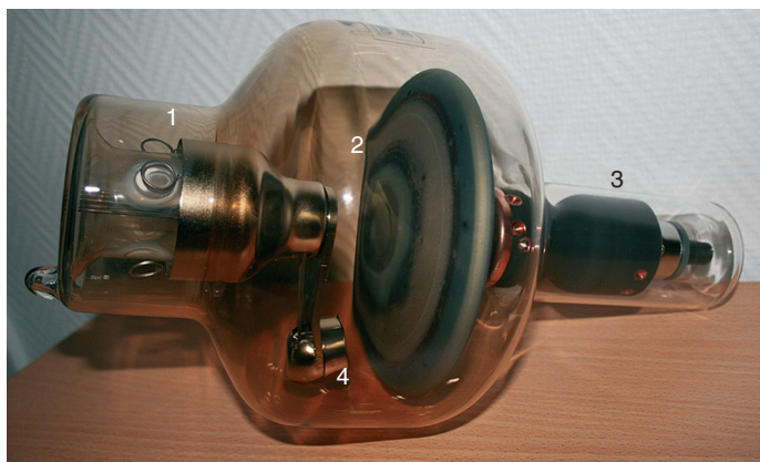
Figure 2. Tube radiogène à anode tournante de 140 mm de diamètre, en graphite. 1. Soudures verre-métal sur le versant cathodique; 2. cathode, ensemble filaments-pièce de concentration; 3. anode tournante dont la piste en tungstène (cible) est dépolie, sous l'action de bombardement électronique; 4. rotor situé à proximité immédiate de la paroi de verre au niveau du col de l'ampoule, pour limiter au maximum la distance séparant rotor et stator, favorisant ainsi l'application des champs électromagnétiques.
