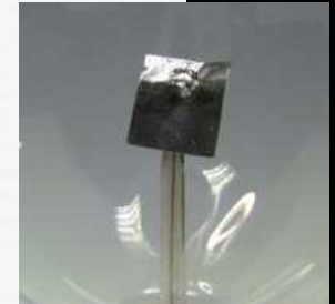
AMPOULE DE CROOKES A FOCUS OU AMPOULE DE RÖNTGEN
