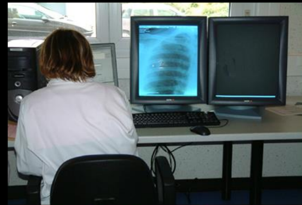
visualisation (soft copy) tubes cathodiques ou écrans plats "portrait" HR 2K x 2K
