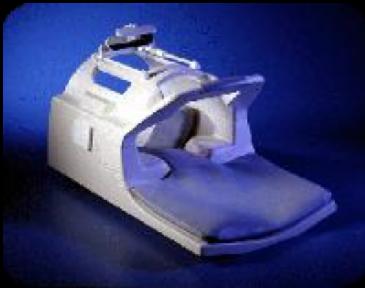
antennes de surface "en réseau phasé" (phased array)
