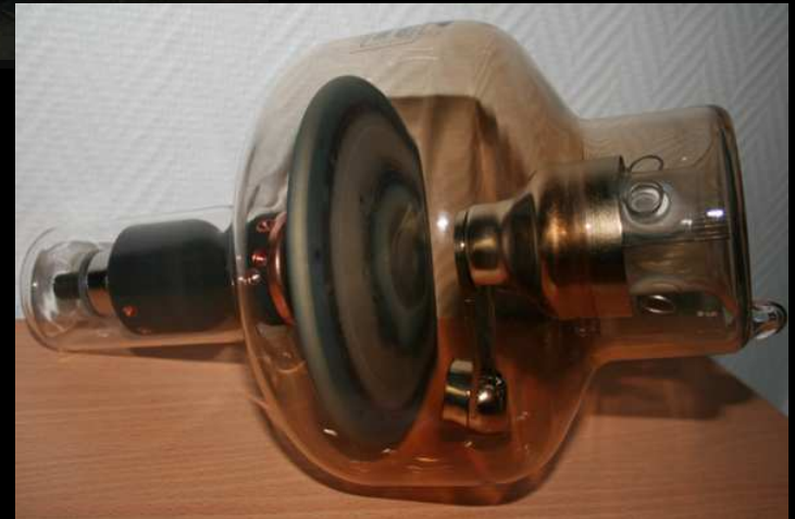
vieillesse du tube "métallisation" des parois
