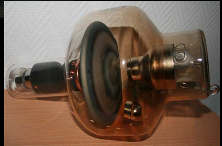
vieillesse du tube "métallisation" des parois
