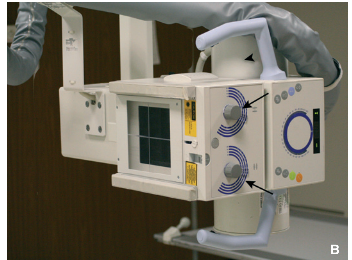
Figure 23. La mobilisation manuelle des diaphragmes s'effectue par rotation des boutons de commande (flèches). L'ensemble diaphragmes localisateurs et centreur lumineux est ancré sur la gaine du tube (tête de flèche).
