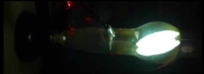
fluorescence du tungstate de calcium (calcite)
