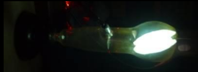
fluorescence du tungstate de calcium (calcite)
