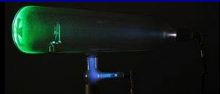
tube à rayons cathodiques "poire" de Hittort
