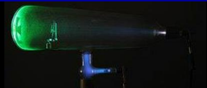
tube à rayons cathodiques "poire" de Hittort
