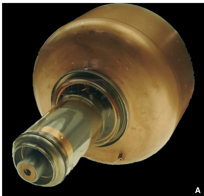
Figure 6. Les tubes à enceinte métallique et jonctions en céramique ont une durée de vie nettement plus longue, en limitant les dépôts métalliques sur les parois (A, B). Le faisceau de rayons X émis ne subit aucune modification (filtration et durcissement par la métallisation du verre de la fenêtre de sortie, avec les enceintes en verre).
